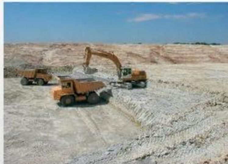
Добыча глины производится при помощи экскаваторов. Машины срезают материал слоями для большей эффективности, т.к. глина залегают пластами.
